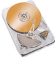
**Hard disk:** sono dischi contenuti all'interno del computer e non sono normalmente estraibili né visibili dall'esterno. I primi modelli avevano una capacità di pochi MByte, i modelli oggi in commercio arrivano fino ad alcune decine di GByte, ma escono continuamente modelli nuovi di capacità sempre maggiore.
