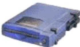
**Zip:** sono dispositivi simili ai drive floppy che usano un disco speciale (disco Zip) di capacità 70 - 170 volte superiore a quella dei normali floppy disk. Sono usati come "backup" (copie di sicurezza di grandi quantità di dati o documenti), oppure per trasferire grandi quantità di dati fra computer diversi.
