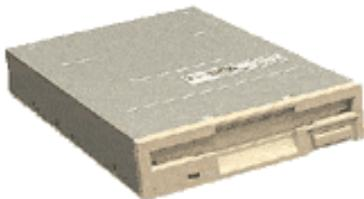
**Drive:** gli sportelli in cui si inseriscono il floppy disk, o il CD, o qualsiasi altro tipo di disco, sono detti "drives" (da non confondersi con i "drivers" software!). Contengono una testina di lettura/scrittura tramite cui avviene il trasferimento dei dati fra disco e macchina.
