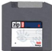
**Zip:** Somigliano ai dischetti floppy ma sono un po' più grandi e la forma è un po' diversa. Esistono da 100 e 250 MByte e necessitano di un drive apposito, diverso da quello dei floppy. Sono piuttosto costosi (da circa 10 Euro a circa 25 Euro l'uno, a seconda della capacità). Sia i dischi che i drive Zip vengono prodotti esclusivamente dalla Iomega.
